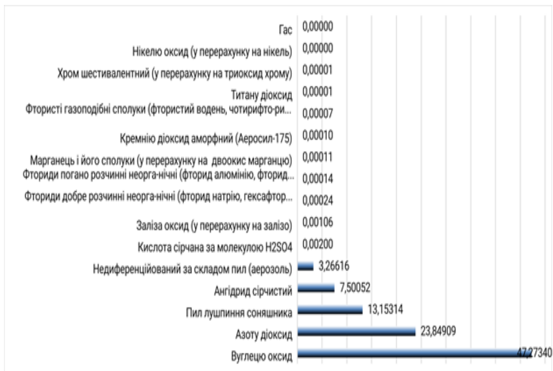
Рисунок 3 – Характеристика викидів забруднюючих речовин від основних виробництв ТЕС потужністю 7 МВт з використанням лушпиння соняшника, т/рік
