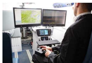
Рисунок 2. Система відображення доповненої реальності для повітряного пожежогасіння та спостереження
