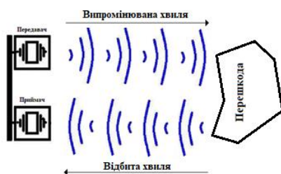
Рисунок 1 – Принцип роботи пристрою акустичної дії
