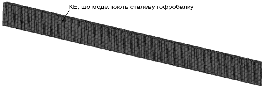
Рис. 1. Кінцево-елементна схема сталеві гофробалки
