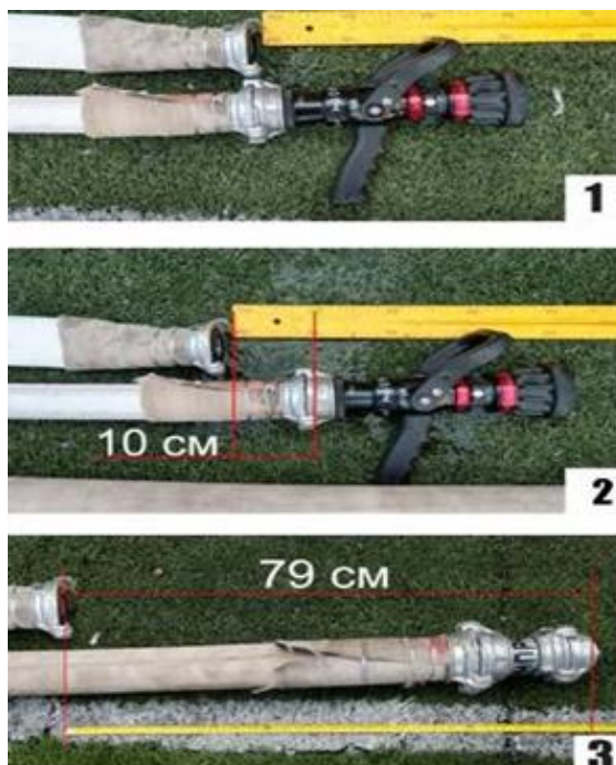
Рис. 1. Вимірювання зміни довжини досліджуваних пожежних рукавів
