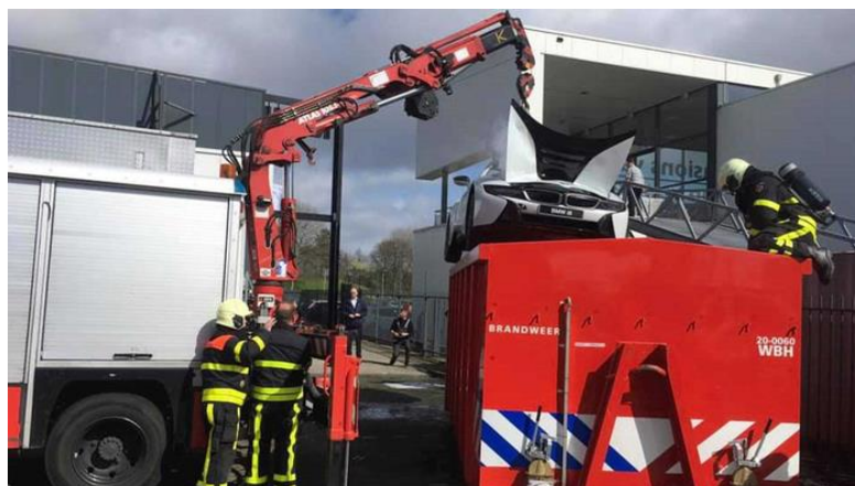
Мал. 1. Пожежний автомобіль – контейнер для гасіння пожеж на електроавтомобілях, для повного занурення автомобіля за допомогою маніпулятора
