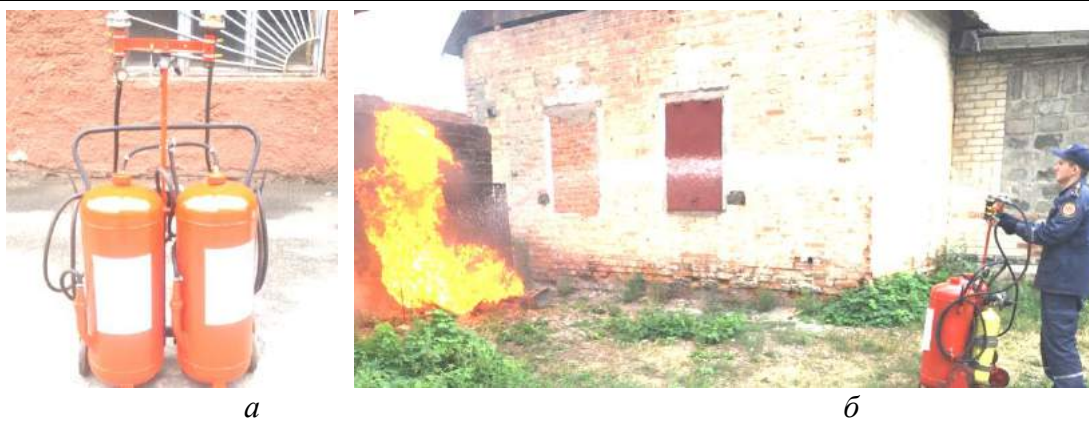
Рис. 3. Автономна установка гасіння гелеутворюючими сполуками АУГГУС – М: а – загальний вид установки; б – установка в роботі
