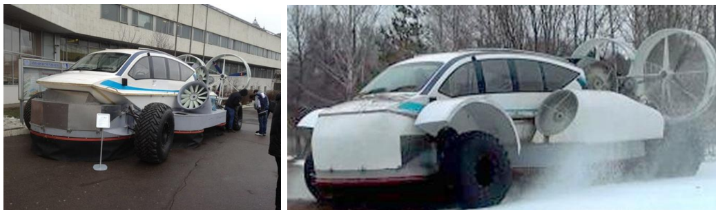
Рис. 4. Экспериментальный прототип «Транспортного средства с воздушной разгрузкой»
