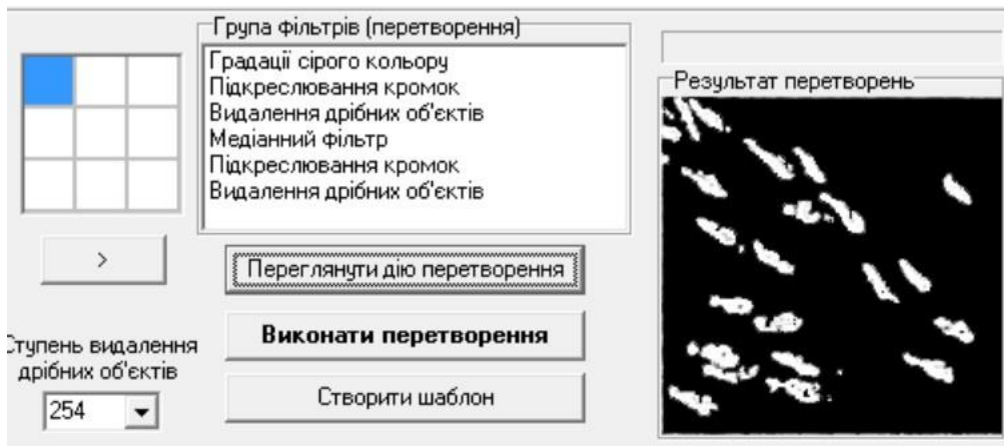
Рис.1. Фрагмент вікна для модуля проектування набору фільтрів із необхідними параметрами перетворення зображення.
