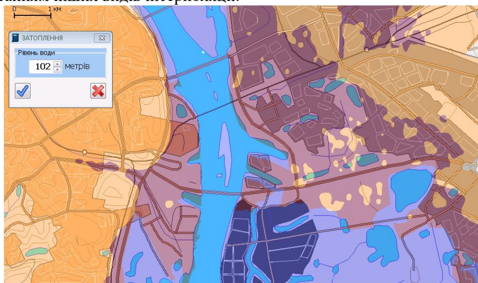
Рис. 2. Вигляд зони можливого затоплення при бікубічній інтерполяції рельєфу
