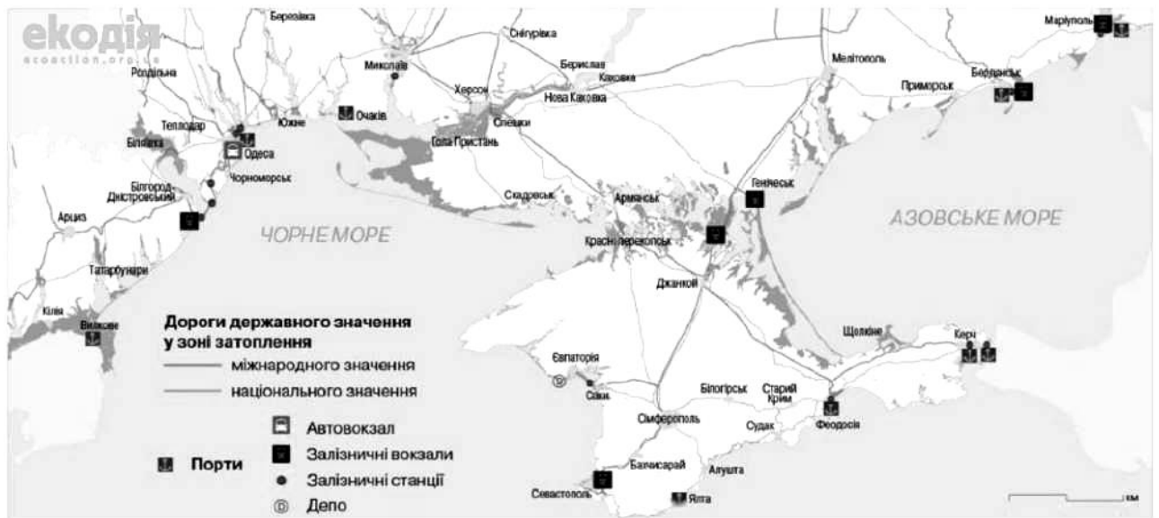
Рис. 1. Порти, вокзали та станції, дороги міжнародного і національного значення, що за прогнозами опиняться в зоні затоплення [8, с. 47]
