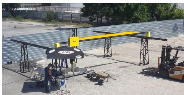
Рис. 1. Портальний будівельний 3D-принтер АМТ
