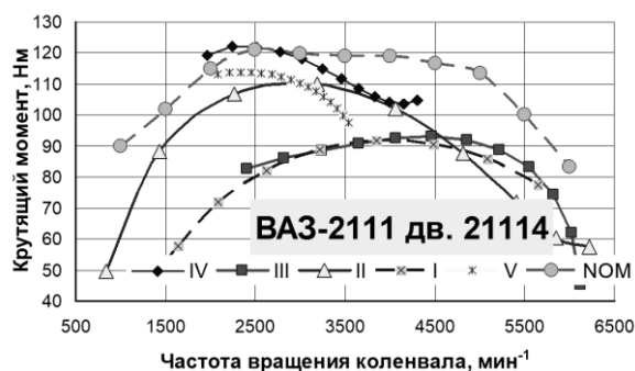
Рис. 6. Кривые крутящего момента, восстановленные по данным разгона Hyundai i30 с двигателем 1,4 (слева) и VAZ-2111 с двигателем 21114
