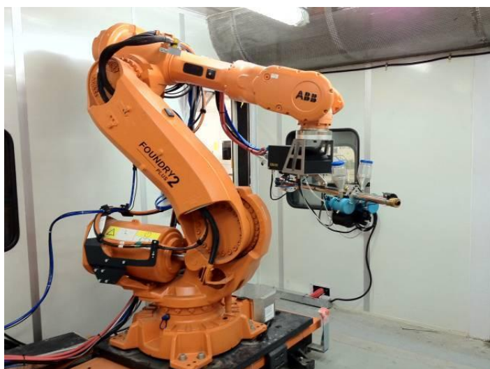
Рис. 1. Установка детонаційно-газового зміцнення «УН-102», встановлена на промисловому маніпуляторі
