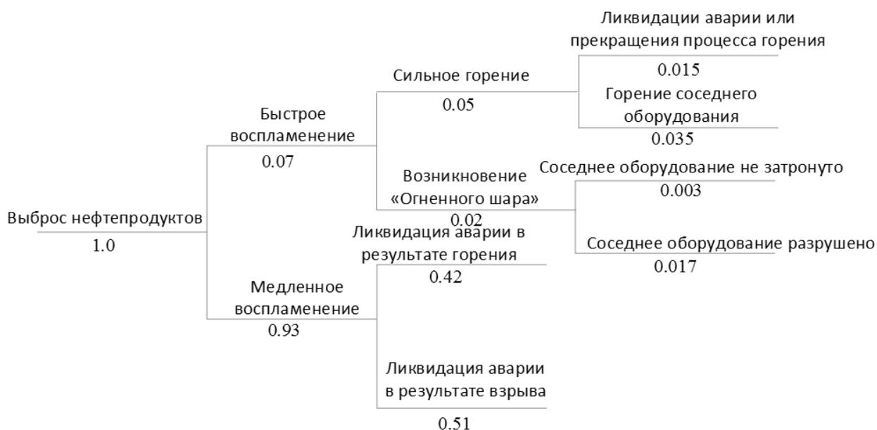
Рисунок 1 – Типовая схема «дерево решений» на установке по переработки нефтепродуктов
