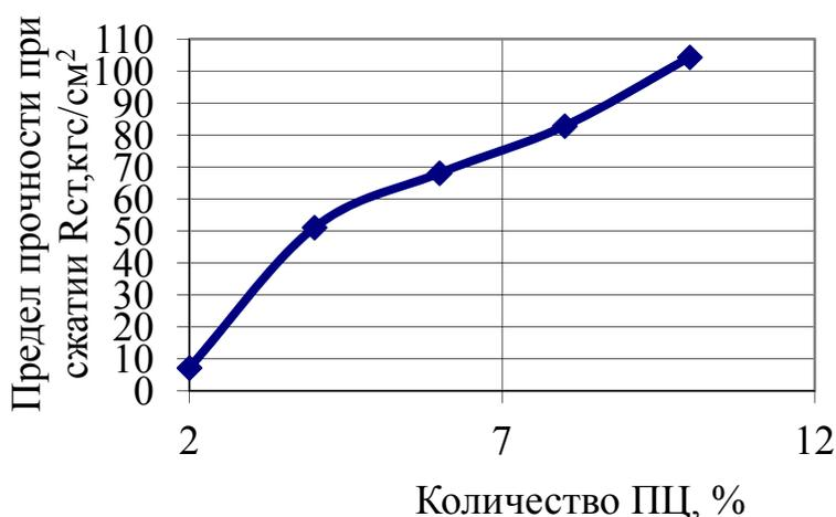
Рисунок 1 - Влияние содержания портландцемента на прочность малоклинкерного жаростойкого вяжущего
