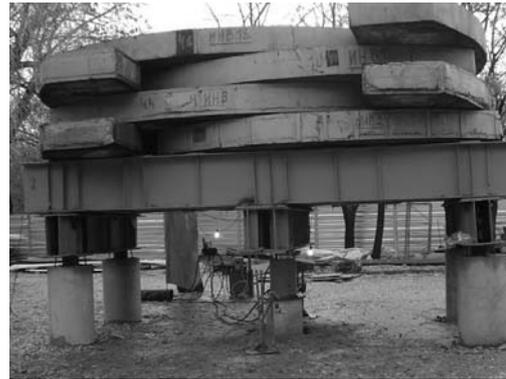
Рис. 6. Испытания сваи статической нагрузкой
