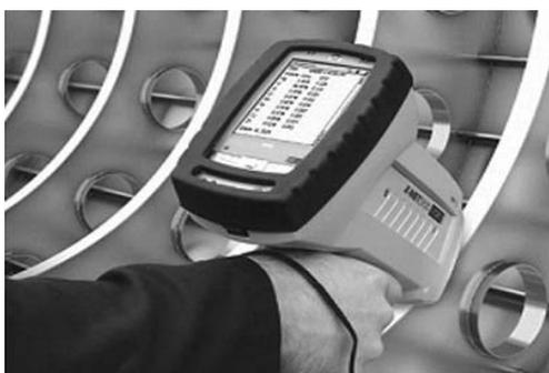
Рис. 3. Рентгенофлуоресцентный анализатор
