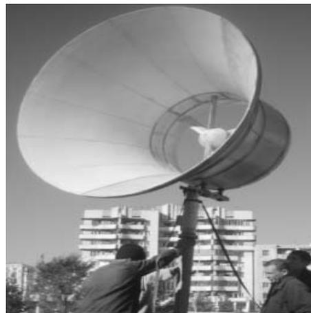
Рисунок 6 - ВЭУД к испытаниям
