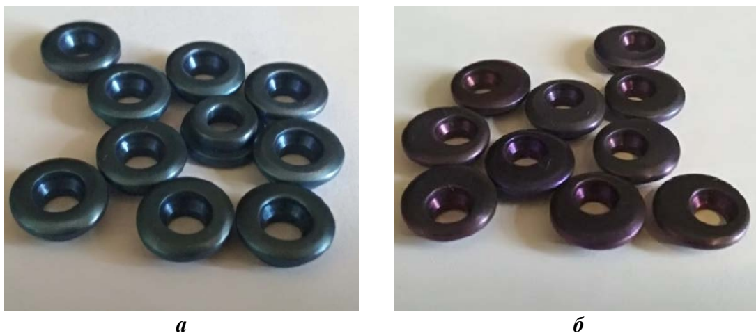
Рис. 1. Імплантати міжхребцевих дисків з оксидним покриттям, одержаним методом електрохімічного оксидування у етиленгліколь-водних електролітах. Кінцева напруга на комірці U , В: a - 30 ; b - 10 .
