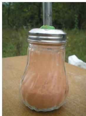
Рис. 1. Ємність для подачі суміші на гасіння полум'я магнію.
