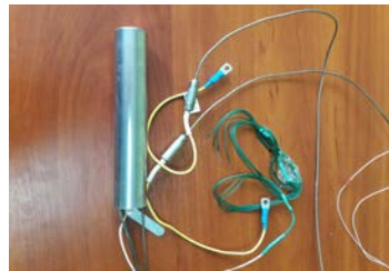
Рис.1. Самокалібруючий датчик температури (СДТ) на основі двох реперних металів з нагрівачем та ПВП
