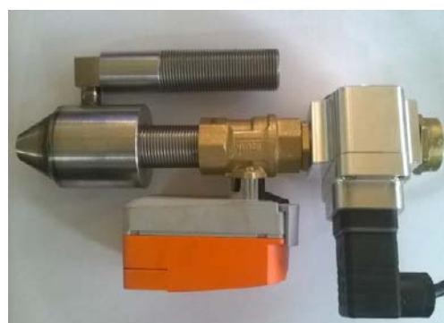
Рис. 2. Дослідницький зразок гідрокавітаційної форсунки
