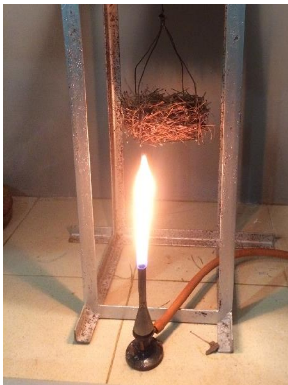
Рис. 1. Лабораторні дослідження вогнезахисної дії лісової підстилки, обробленої ГУС при прямому впливі полум'я
