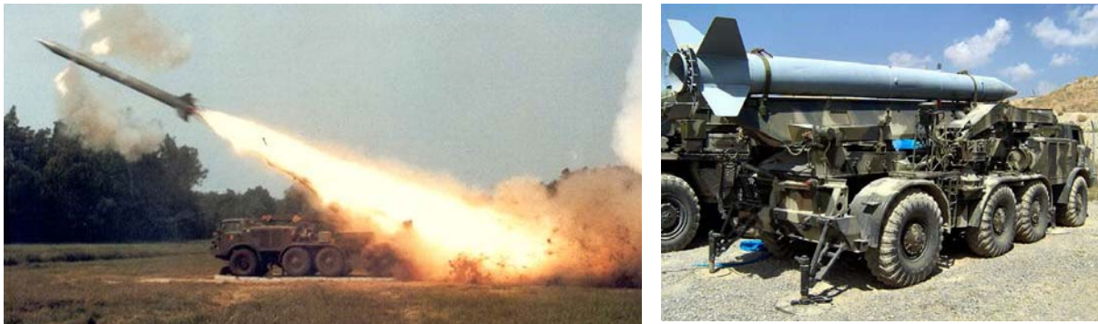
Рис. 2. Самохідна пускова установка 9П113 комплексу 9К52 «Луна-М» на шасі «ЗІЛ-135ЛМ»
