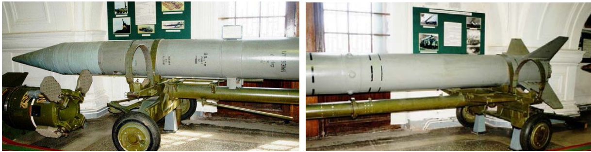
Рис. 1. Ракета 9М21Ф на транспортному візку (9ТР111)
