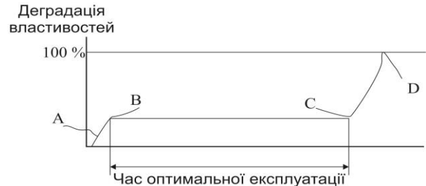
Рисунок 1 – Період експлуатації конструкційного елемента газотранспортної системи на прикладі ПрАТ «Енергооблік», м. Харків
