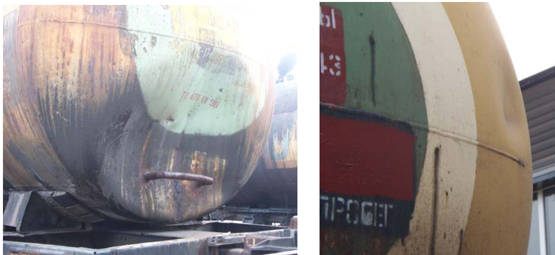
Рис. 1 – Фотографии повреждений цистерн типа «вмятина»
