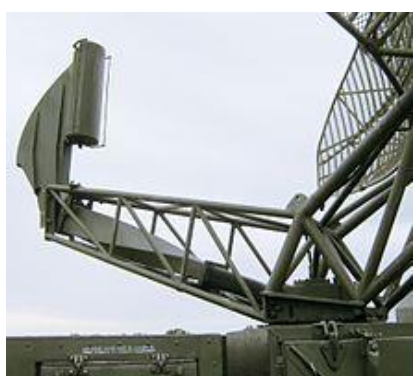
Рисунок 1. -Прямоугольные волноводы передают СВЧ-излучение к облучателю антенны радара
