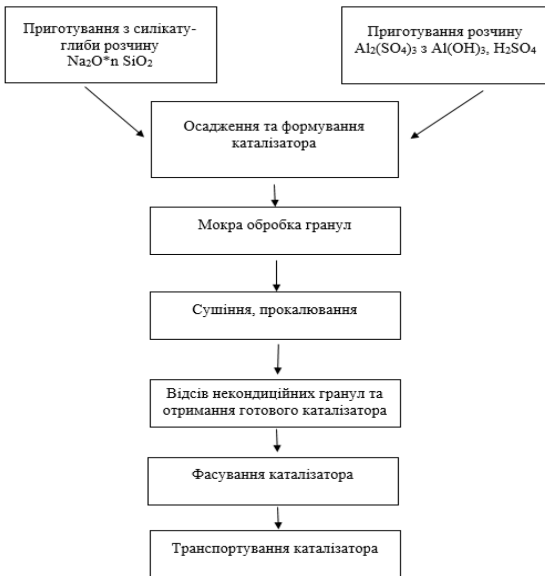
Рисунок 1 – Принципова технологічна схема отримання мікросферичного алюмосилікатного каталізатора.
