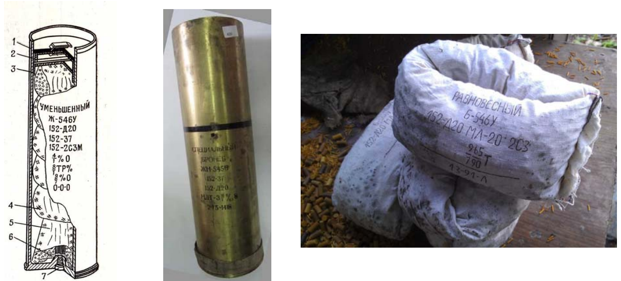
Рисунок 1.7 – Зменшений змінний бойовий заряд индекс Ж-546У (по ВБК –Б-546У) для ВО14 вагою 4,317 кг: 1 – посилена кришка У №12 з тасьмою залита сумішшю ПП-95/5; 2 – нормальна кришка НШ №8; 3 – гільза індексу 54-Г-540 (ЛК-75-05) = 7,5 кг; 4 – додатковий рівноважний пучок 4/1 = 1,215 кг; 5 – основний пакет з пороху марки 9/7 = 2,775 кг і 8/1 тр = 0,1 кг; 6 – запальник з ДРП-1 = 0,05 кг.; 7 – КВ-4 (54-К-001)
