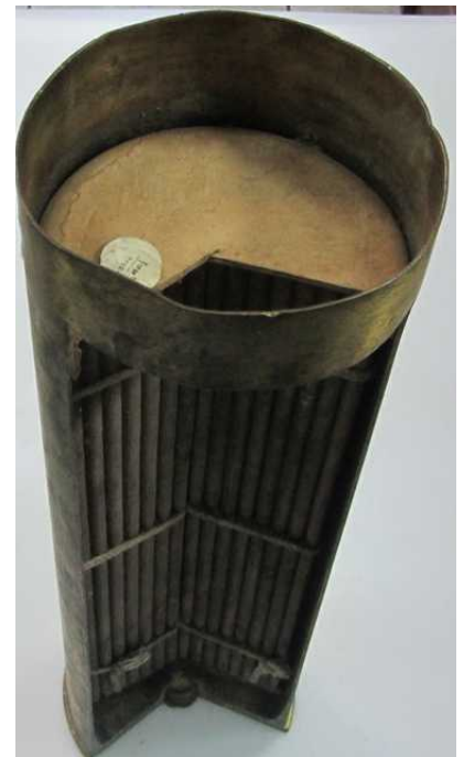
Рисунок 1.10 – Г-540 з КВ-4 та повним змінним бойовим зарядом індексу 54-ЖН-546 (по ВБК БН-546) (знизу полум'ягасник з порошу марки 8/1УГ = 0,18 кг та запальник з ДРП-1 = 0,15 кг, зверху нормальна кришка НШ №8)
