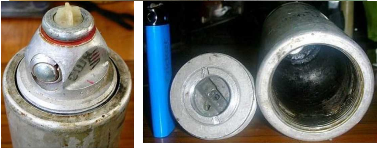
Рисунок 1.3 – Осколковий бойовий елемент О16 = 1,375 кг (8 шт.): 1 – сталевий корпус; 2 – втулка перехідна (кільце різьбове); 3 – прокладка; 4 – А-1Х-2 = 0,23 кг; 8 – підрильник И-356М1 (9Э246М1) = 0,1 кг (Для 152 мм ВО13 і ВО14 з касетним снарядом О13 (ОБЕ О16 – 8 шт.) «Сахароза» та 203-мм постріли ВО15 і ВО16 з касетним снарядом О14 (ОБЕ О16 – 24 шт.) «Склад» під маркою И-356М1(9Э246М1) (1984 р.) та у ОБЕ 300 мм РСЗО «Смерч» під маркою 174В3 (1987 р.)
