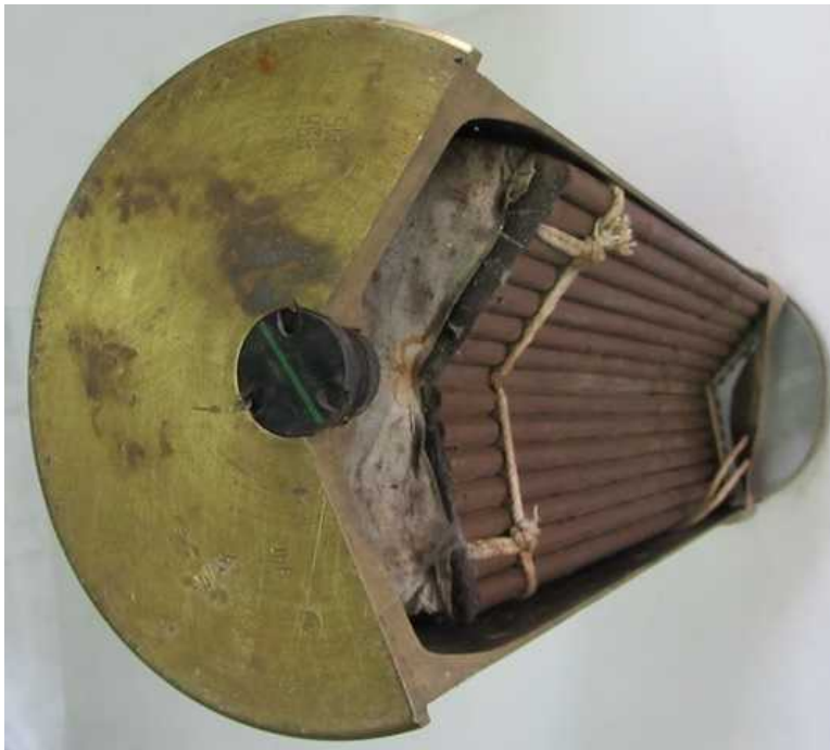
Рисунок 1.10 – Г-540 з КВ-4 та повним змінним бойовим зарядом індексу 54-ЖН-546 (по ВБК БН-546) (знизу полум'ягасник з порошу марки 8/1УГ = 0,18 кг та запальник з ДРП-1 = 0,15 кг, зверху нормальна кришка НШ №8)
