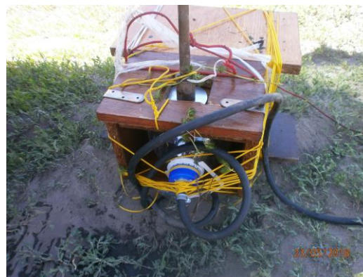
Рис. 2. Варіанти використаних під час експериментальних досліджень макету донної ПДМ зі штировим датчиком цілі
