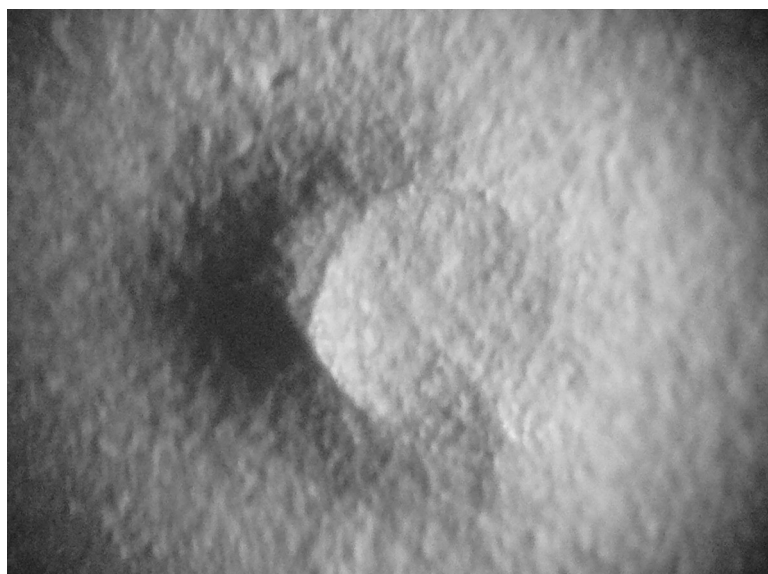
Рис. 6.60 – Сегнетокерамическое покрытие состава (\text{Ba}_{0,75}\text{Sr}_{0,25})(\text{Ti}_{0,95}\text{Zr}_{0,05})\text{O}_3 , нанесенное на медную подложку методом вакуумного аэрозольного напыления при комнатной температуре
