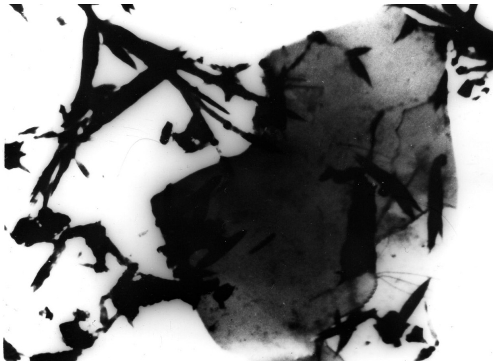
Рис. 5.26 – Гидратированный алюмотитанобариевый цемент под электронным микроскопом; увеличение: \times 6000
